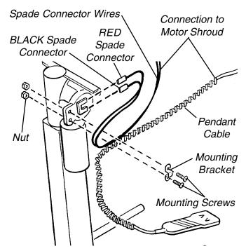
FIGURE 4 - REMOVING THE MOTOR SHROUD - RELEASING THE CABLES
